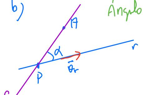
$$\alpha = (r, s) = \arccos \frac{|\vec{v}_r \cdot \vec{v}_s|}{|\vec{v}_r| |\vec{v}_s|} \quad \vec{v}_s = \vec{PA}$$
